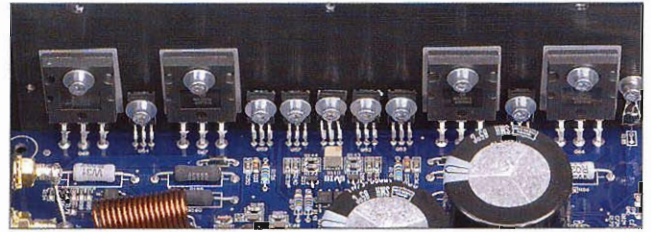
Leistungssymmetrisch: Positive und negative Signalhalbwellen werden von exakt symmetrischen Endstufenhälften verstärkt
