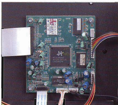
Die Systemsteuerung nimmt auf einer separaten Platine Platz
